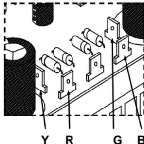
**⚠ Ne modifiez pas l'ajustable de la tension de polarisation!**
